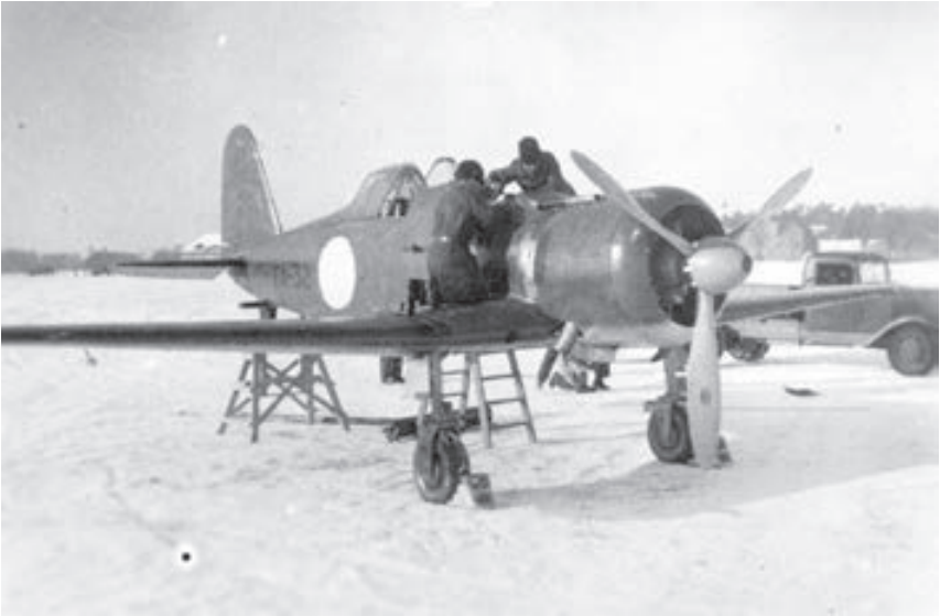
FA-32 har riggats upp på Karlsborgsfältet för inskjutning av kulsprutorna över Vättern under överinseende av den italienske mekanikern Athos Passeri. Den 12 mars 1940 hämtades FA-32 i Västerås och flögs till Finland tillsammans med FA-33. Under fortsättningskriget sköt det ner sex fiendliga plan. Foto: Karlsborgs fästningsmuseum
