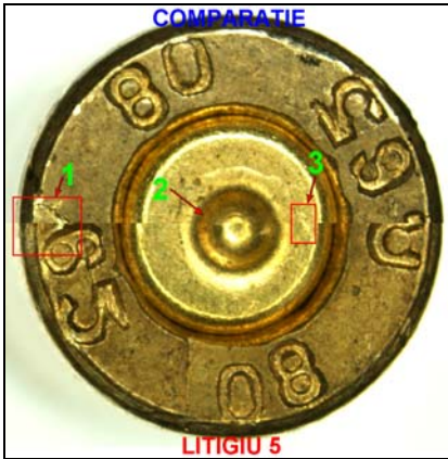
Fig. 3. Continuitatea liniară la nivelul caracteristicilor individuale (microrelieful neregularităților) conținute de ejector, cuiul percutor și peretele frontal al închizătorului, obținută prin juxtapunerea orizontală a imaginilor rozetei unui tub-cartuș în litigiu (notat LITIGIU 5) și a rozetei unui tub-cartuș model de comparație (notat COMPARATIE), efectuată cu ajutorul programului Lucia Forensic
