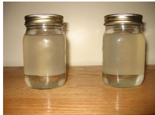
Muestra de agua en el combustible. Obsérvese como se deposita al fondo del recipiente, por tener esta mayor densidad que el combustible.
