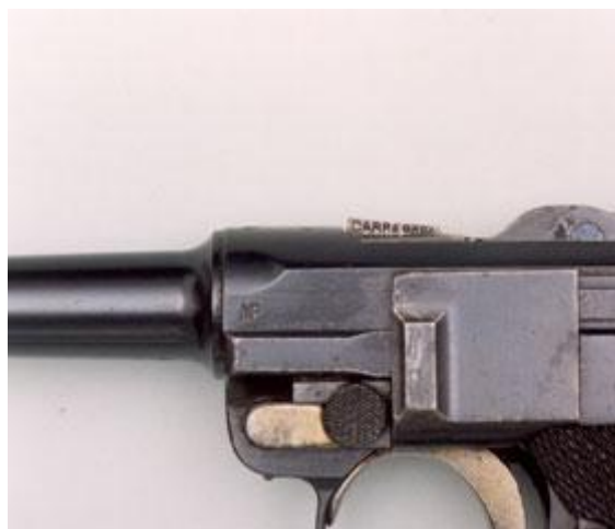
fig. 10 - Pormenor do extractor da Pistola Parabellum M/908 onde se pode ler a palavra "CARREGADA" quando este se encontra elevado por se encontrar uma munição na câmara e pormenor da punção MP, punção de verificação aplicada em Portugal pela comissão de recepção e verificação da Marinha de Guerra Portuguesa.
