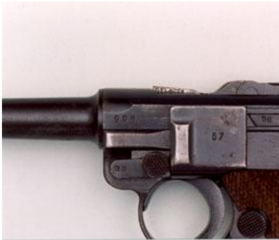
fig. 15 - Pormenor do extractor da Pistola Parabellum M/943 onde se pode ler a palavra "GELADEN" quando este se encontra elevado por se encontrar uma munição na câmara.
