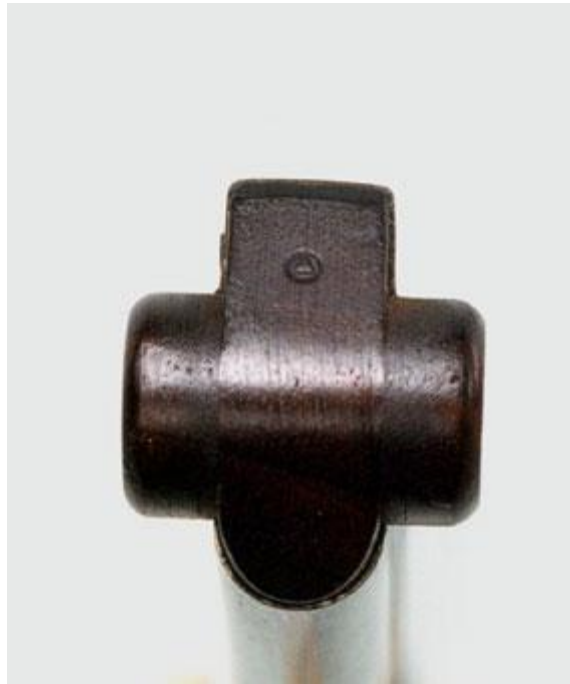
fig. 6 Pormenor do extractor da Pistola Parabellum M/908 onde se pode ler a palavra "CARREGADA" quando este se encontra elevado por se encontrar uma munição na câmara, assim como a punção de verificação, aplicado em Portugal, pela comissão de recepção destas armas. Fig. 8.a) Pormenor da base do carregador da pistola Parabellum m/908 onde se pode observar a punção de verificação do AE.
