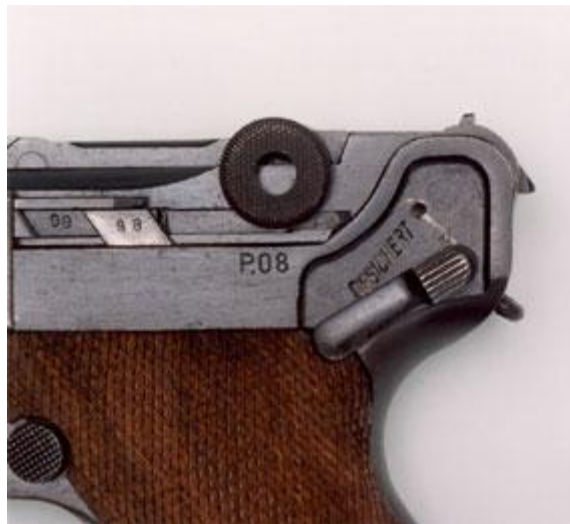
fig. 16 - Pormenor da alavanca de segurança de polegar da pistola M/943 em posição de segurança, onde se pode observar a palavra "GESICHERT"
