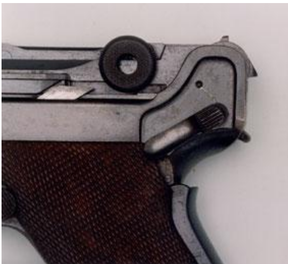
fig. 7 - Pormenor da alavanca de segurança de b) em posição de segurança, onde se pode
