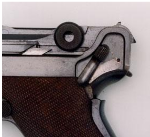
fig. 7 - Pormenor da alavanca de segurança de b) em posição de segurança, onde se pode
