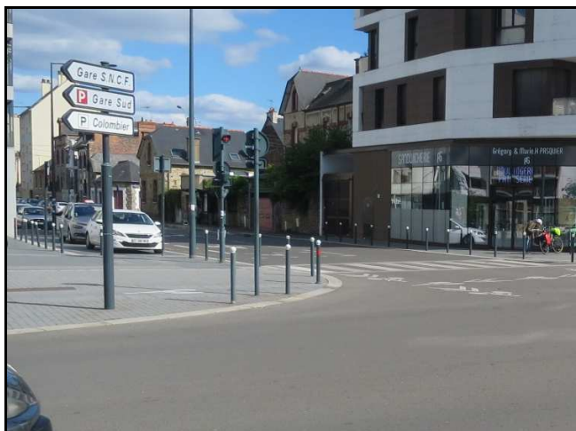
Rayon de giration réduit et potelets (Rennes)
