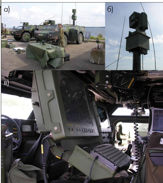
Рис.5. Машина Бундесвера Fenpek: а – общий вид, б – оптический визир, в – внутренний интерьер
