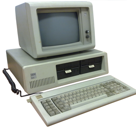
Figura 1.3: La computadora IBM PC modelo 5150 (1981), iniciadora de la arquitectura predominantemente en uso hasta el día de hoy (imagen de la Wikipedia: IBM Personal Computer ).
