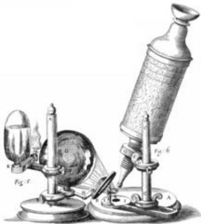
Gambar. Mikroskop rancangan Robert Hooke menggunakan sumber cahaya lampu minyak
