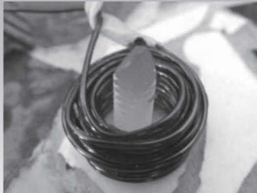
Gambar 25.7 Arus Listrik dan Medan Magnet Koil yang dialiri arus listrik akan menimbulkan medan magnet
