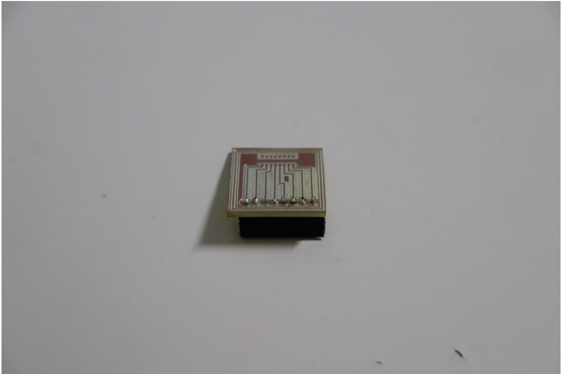
Σχήμα 28: Η πλακέτα μετά την κόλληση του συνδετήρα
