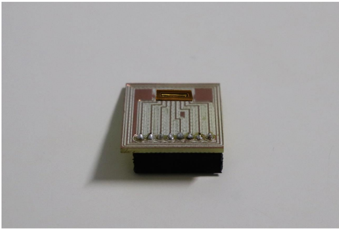
Σχήμα 29: Η πλακέτα ολοκληρωμένη μετά και την κόλληση του αισθητήρα
