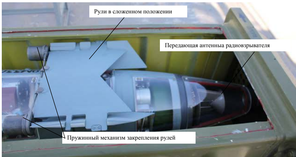
Рис. 11. Первый и второй отсеки ракеты в контейнере
