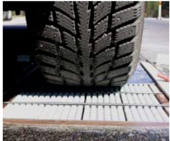
Kuva 21. VTT:n yliajokokeen graniitista valmistettu kulutuskoekappale (Unhola 2004, s. 14)
