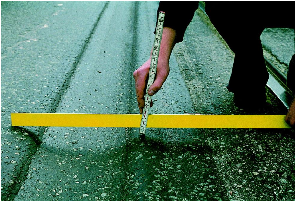
Kuva 4. Ajoura ja urasyvyyden mittaaminen oikolaudalla. Kuvan mittaustapa ei ole standardinmukainen. (Garba 2002, s. 12)
