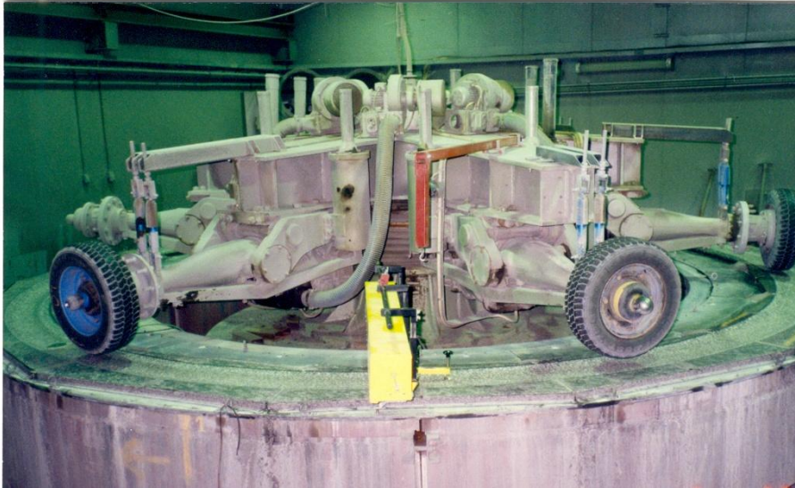
Kuva 20. VTT:n testeissä käytetty kulusrata (Jacobson & Wågberg 2007, s. 27)
