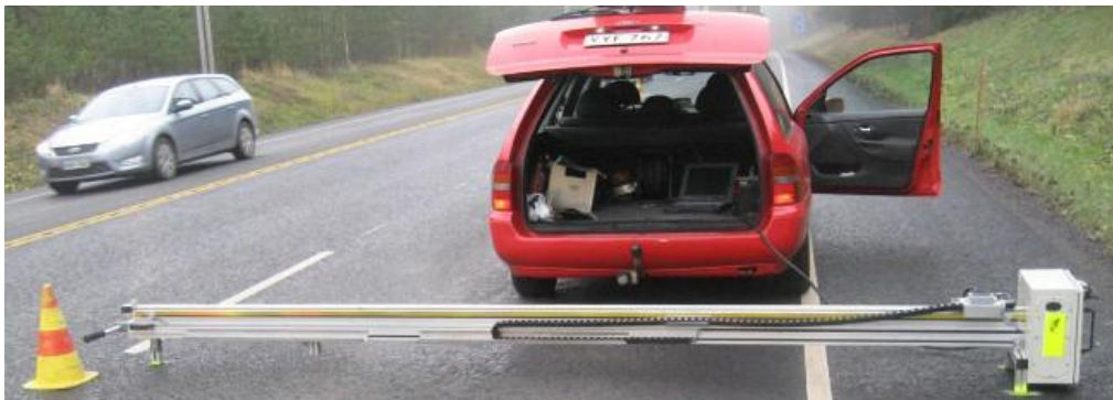
Kuva 29. Aalto-yliopiston Tielaboratorion siirrettävä laserprofilometri ( http://civil.tkk.fi/fi/tutkimus/tietekniikka/tutkimus/tutkimuslaitteet/ )
