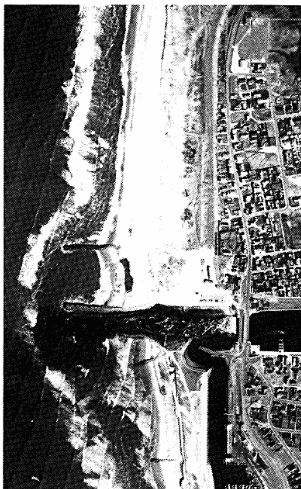
Fig. 2. Flyfoto fra 1981 orienteret med nord opad. Det viser en del af Torsminde by og havn med sluseanlæg og ydre havneværker. Revlens beliggenhed foran kystlinien markeres tydelig af brådzonen, der fremkaldes af de indløbende bølger fra nord-vest.
