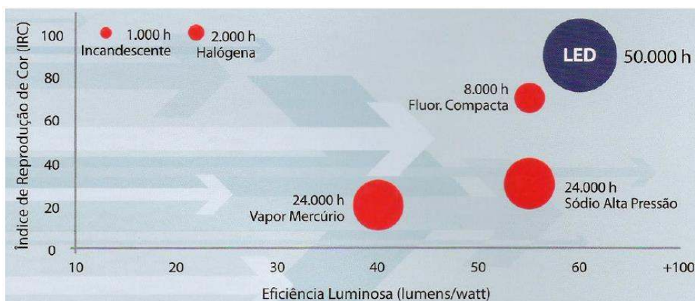
Figura 2: Eficiência luminosa, IRC e vida útil - Fonte: PROFOTON (2016, p. 5)
