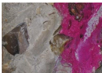
©setec LERM. Carbonatation d'un béton (zone non colorée). Test à la phénolphthaléine
