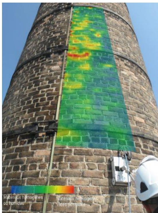
©setec LERM. Radar. Principe de représentation cartographique d'anomalies.
