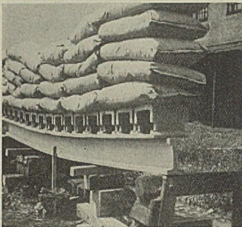
Abb. 9. Die Belastung ist weiter gesteigert worden. Die Durchbiegung in Balkenmitte beträgt etwa 8 cm.
