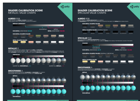
▲图 18.8 Unity 提供的校准表格。左边：金属工作流使用的校准表格，右边：高光反射工作流使用的校准表格
