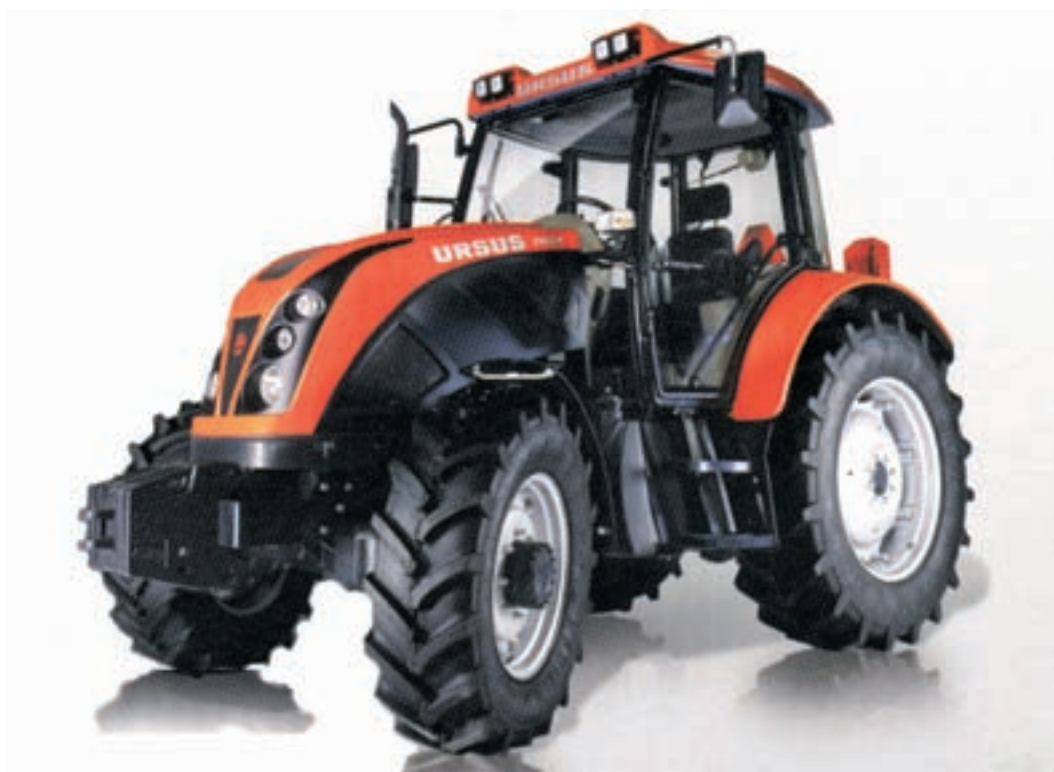
Fot. 183. Ciągnik URSUS 11024 firmy Ursus SA [38]: silnik turbodiesel Perkins 1104D EURO IIIA, moc 110 KM, skrzynia biegów 12/4 synchronizowana, napęd 4x4, most przedni Carraro, układ kierowniczy pełnohydrauliczny
