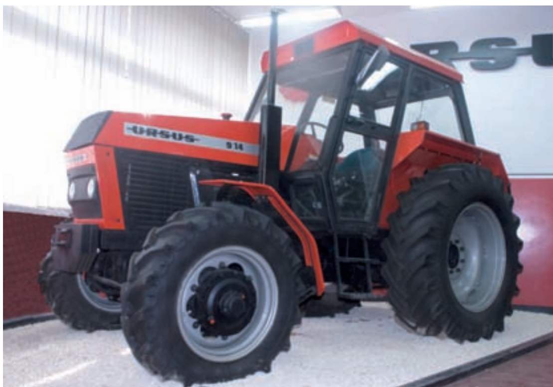
Fot. 163. Ciągnik Ursus 914, wersja ciągnika Ursus 912 z napędem na obie osie. Ekspонат wystawiony w Muzeum ZM Ursus (fot. B. Kryński)
