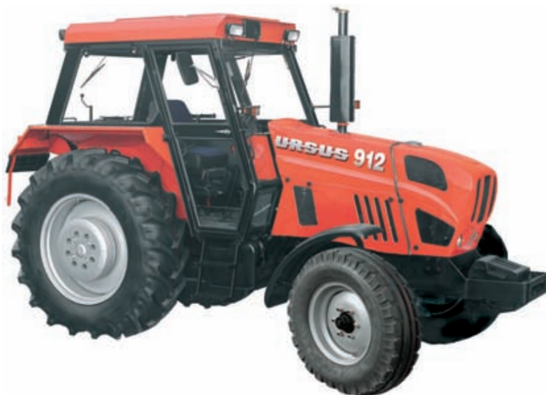
Fot. 170. Ciągnik Ursus 912 z nową maską i dachem kabiny z tworzywa (ze zbiorów Muzeum ZM Ursus)
