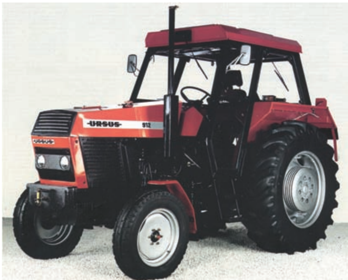
Fot. 162. Ciągnik Ursus 912 o mocy ok. 58 kW, modernizacja „B” ciągników ciężkich produkowana od 1984 r. (wg [31])
