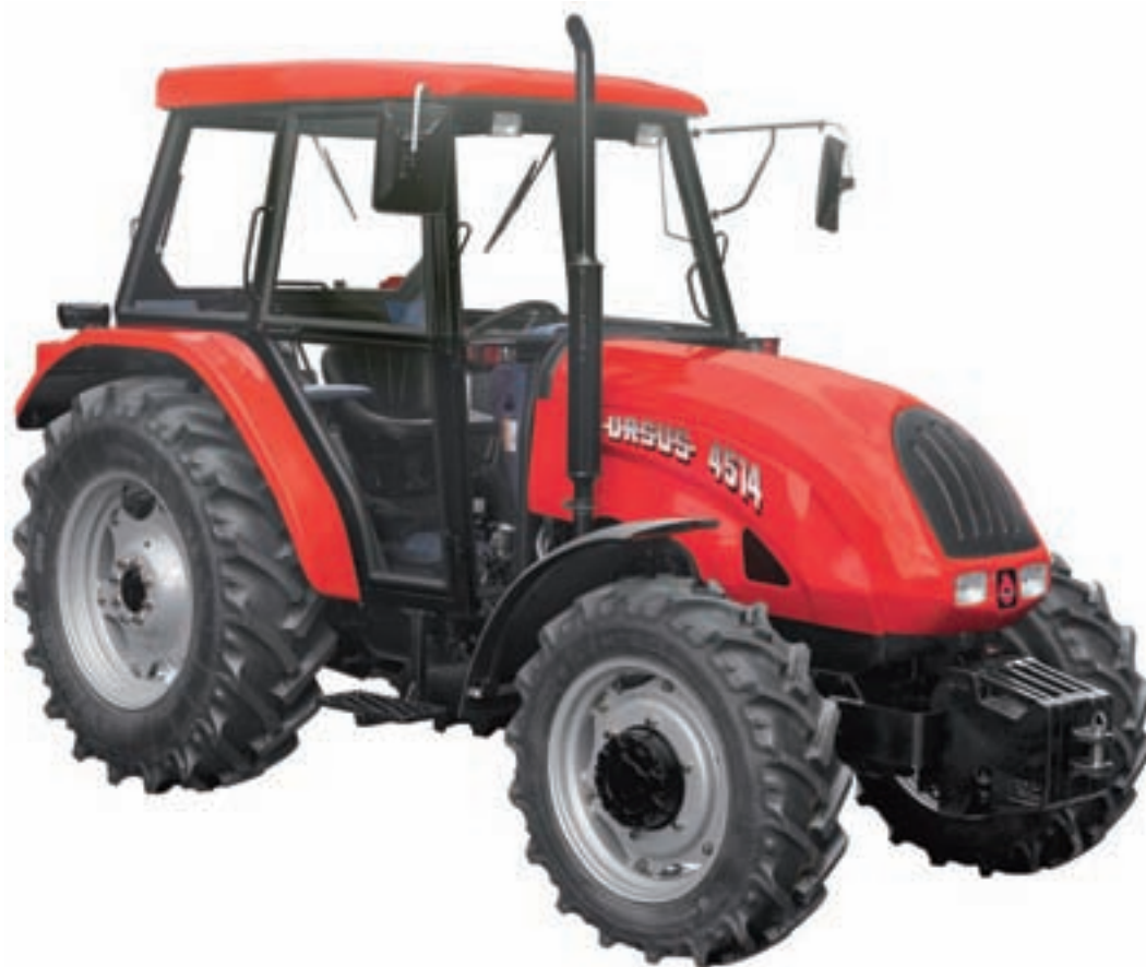
Fot. 156. Ciągnik Ursus 4514 z silnikiem 44 kW wersja z napędzaną osią przednią i maską z tworzywa sztucznego produkowana od 2002 r. (ze zbiorów Muzeum ZM Ursus)
