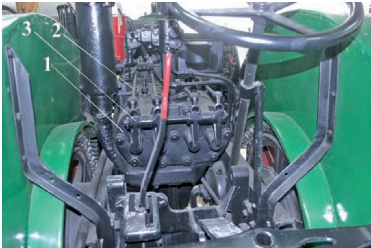
Fot. 13. Widok silnika „Ciągówki”: 1 – głowica, 2 – popychacz, 3 – klawiatura zaworów. Fotografia eksponatu w Muzeum ZM Ursus (fot. Bartosz Kryński)
