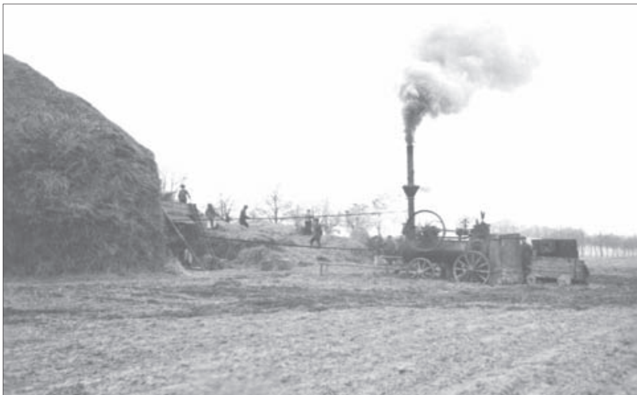
Fot. 23. Lokomobila parowa napędzająca młockarnię w majątku „Nawra” (fot. ze zbiorów rodziny Szczanieckich, właścicieli majątku)
