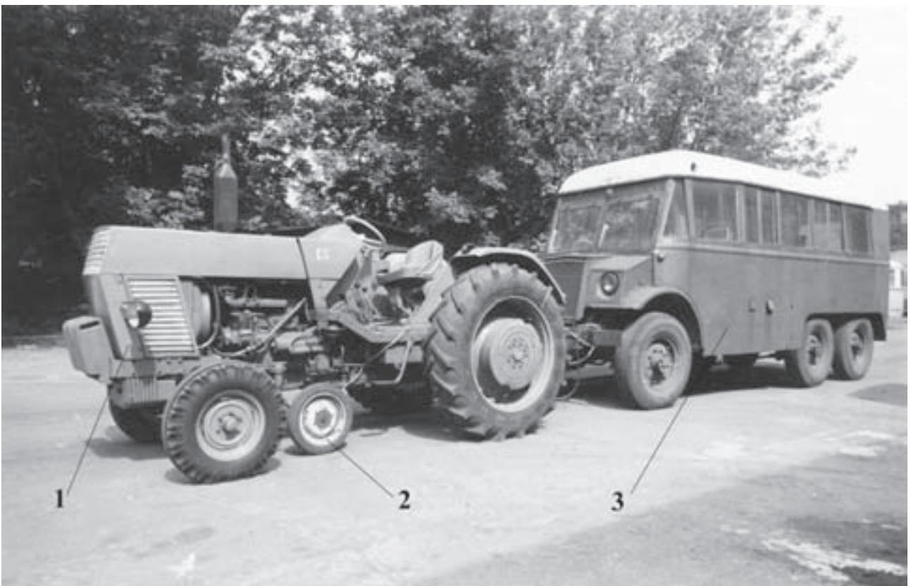
Fot. 119. Badania trakcyjne prototypu ciągnika NUR 1.4 z przyczepą dynamometryczną: 1 – ciągnik, 2 – urządzenie pomiarowe, tak zwane piąte koło, 3 – przyczepa dynamometryczna
