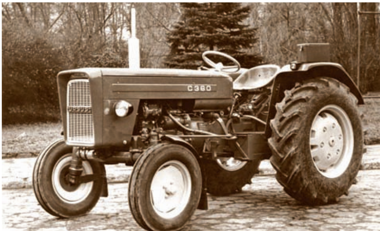
Fot. 101. Ciągnik Ursus C-360 z silnikiem o mocy 52 KM produkowany w ZM Ursus w latach 1976-1994 (ze zbiorów Muzeum ZM Ursus)
