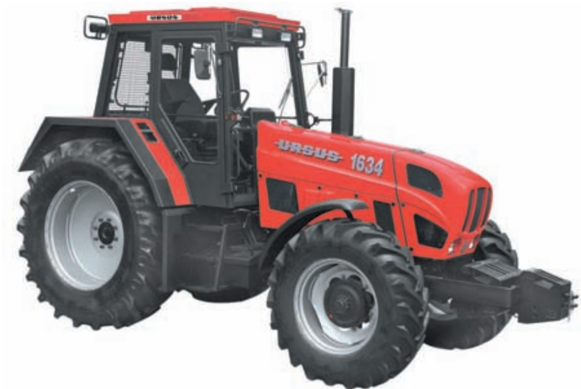
Fot. 172. Ciągnik Ursus 1634 produkowany od 2004 z silnikiem DS Martin o poziomie spalin I. Jest już z maską i dachem kabiny z tworzywa w nowej stylistyce. Z napędem na obie osie przeznaczony dla leśnictwa (ze zbiorów Muzeum ZM Ursus)
