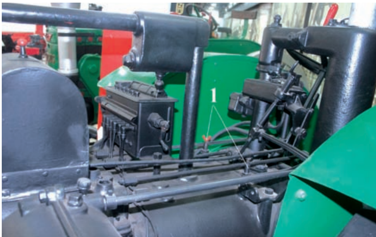
Fot. 14. Szczegóły instalacji wodnej chłodzenia silnika, zapłonowej i olejenia: 1 – elementy zapłonowe. Fotografia eksponatu w Muzeum ZM Ursus (fot. Bartosz Kryński)
