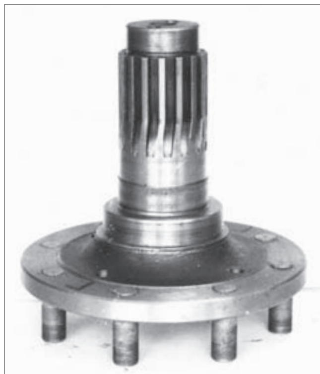
Fot. 98. Lekko skrzywiona półoś ciągnika Ursus C-4011 po badaniu wytrzymałości doraźnej na stanowisku fot. 97.
