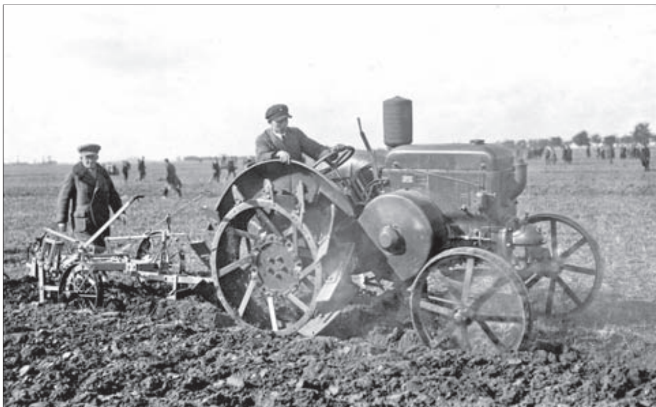
Fot. 20. Jak fot. 19, tu również ciągnik Lanz Bulldog. Widać wyraźnie stalowe koła z dużymi ostrogami ([32])
