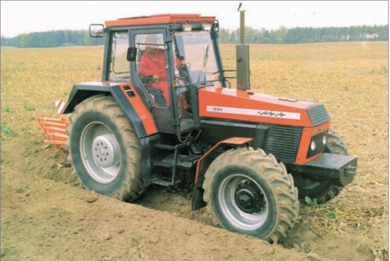
Fot. 164. Ciągnik Ursus 1634 z silnikiem o mocy ok. 114 kW produkowany od 1991 r. (wg [34])
