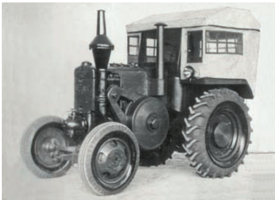
Fot. 49. Pod koniec produkcji Ursus C45 oferowany był również z brezentową kabiną (fot. ze zbiorów Muzeum ZM Ursus)
