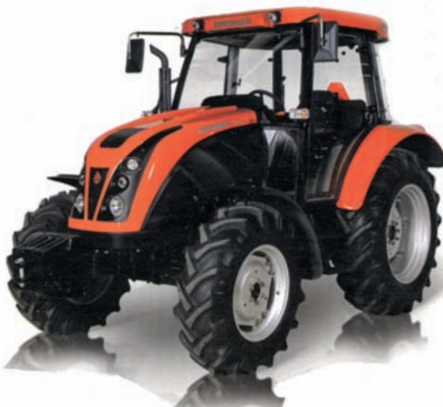
Fot. 185. Ciągnik URSUS 10014T firmy Ursus SA [38]: silnik turbodiesel Deutz TCD3. 6L4 Euro IIIB, moc 105 KM, skrzynia biegów 32/32 z rewersem elektrohydraulicznym synchronizowana, napęd 4x4, podnośnik EHR, układ kierowniczy pełnohydrauliczny
