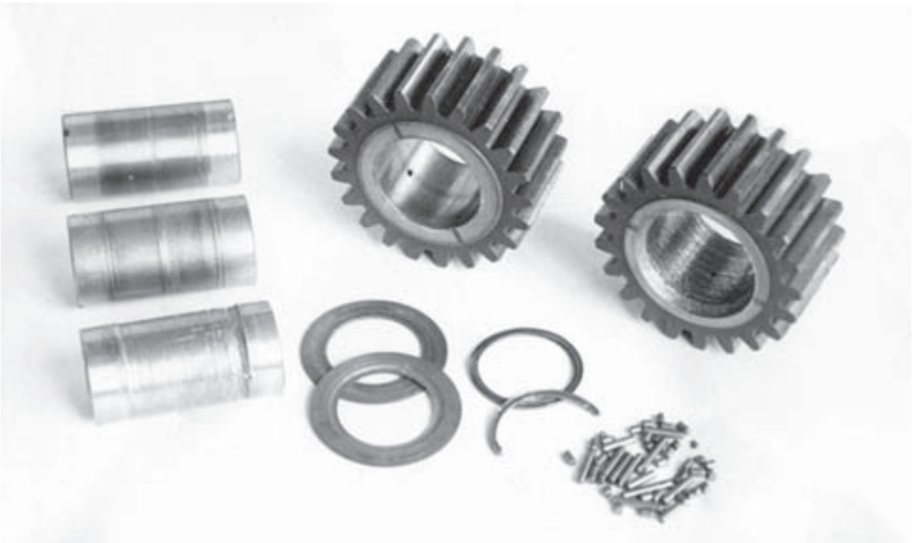
Fot. 118. Uszkodzone łożyska igłowe satelitów wzmacniacza momentu prototypu ciągnika NUR 1.4 po przepracowaniu ok. 200 godzin pod obciążeniem na stanowisku (fot. ze zbiorów Katedry Ciągników PW)
