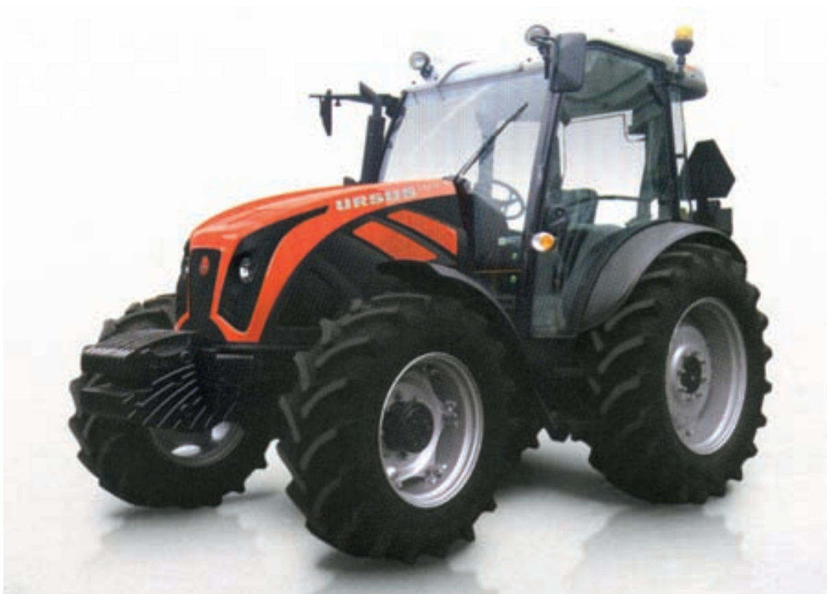
Fot. 182. Ciągnik URSUS 10014H firmy Ursus SA [38]: silnik turbodiesel Perkins 1104D EURO IIIA moc 102 KM, skrzynia biegów 12/12 synchronizowana z rewersem mechanicznym, układ kierowniczy pełnohydrauliczny
