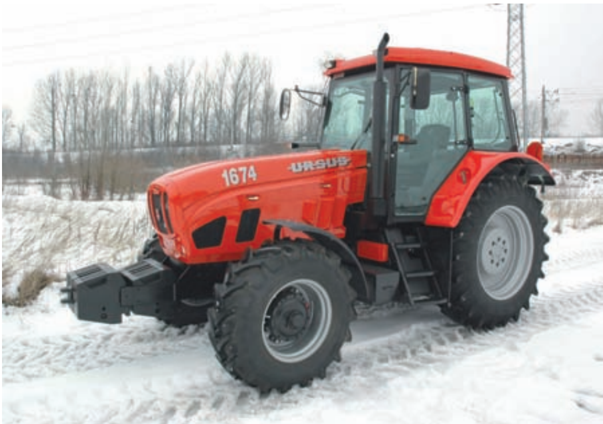
Fot. 173. Ciągnik Ursus 1674 z silnikiem ok. 116 kW Perkins 1106-EEE66TA EURO III z napędem na obie osie z maską i dachem kabiny z tworzywa (ze zbiorów Muzeum ZM Ursus)
