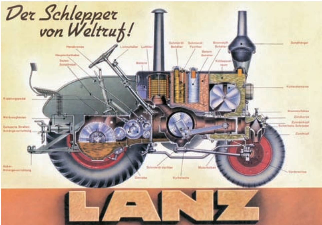
Fot. 33. Ciągnik LANSZ Bulldog wersja zmodyfikowana ze skrzynią biegów 6-cio biegową produkowana od 1936 r. [5]
