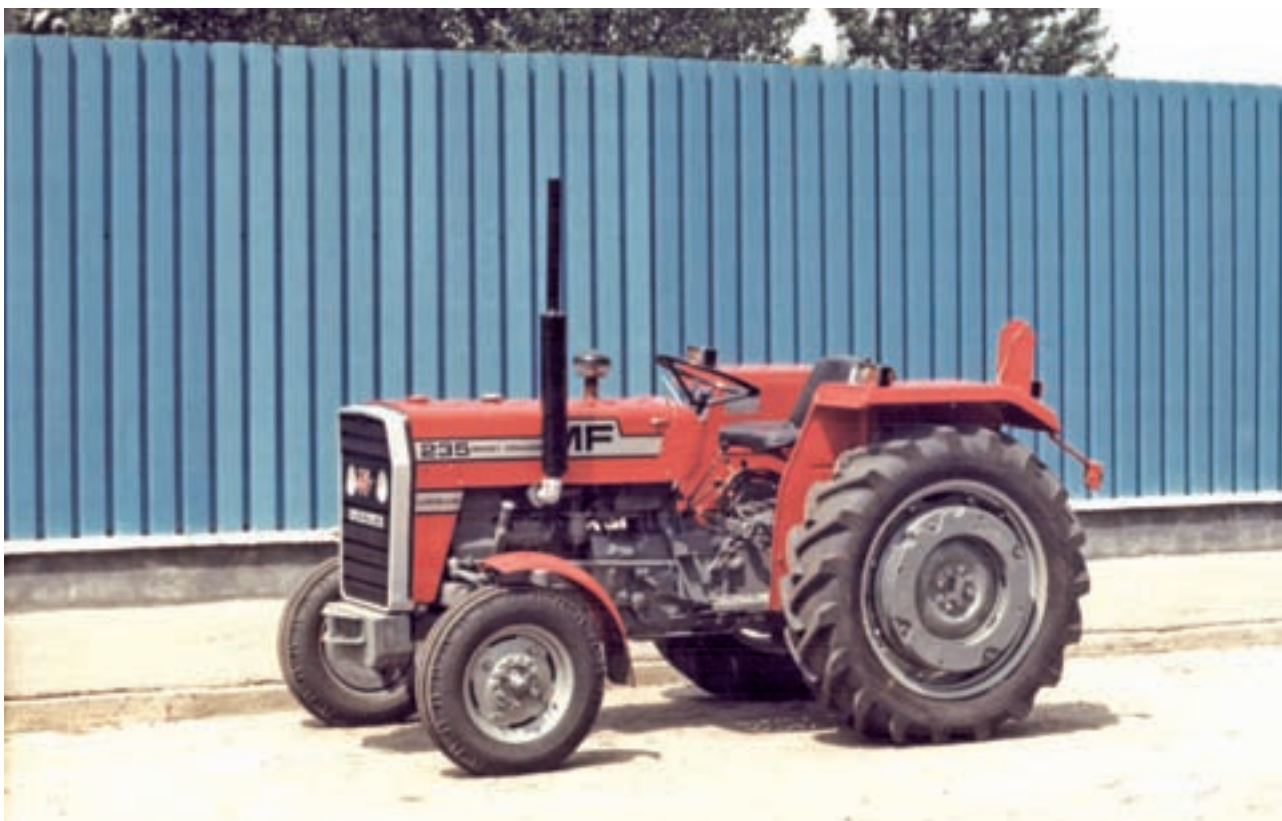
Fot. 146. Ciągnik licencyjny MF 235, wersja pomostowa bez kabiny. Pierwszy egzemplarz tak zwany szkolny zmontowany w 1978 r. z części importowanych. Widoczne logo Massey Ferguson i tabliczka URSUS (ze zbiorów Muzeum ZM Ursus)
