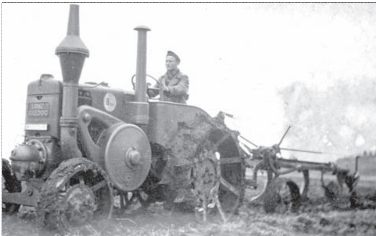
Fot. 31. Rok 1942 okolice Krakowa orka za pomocą ciągnika Lanz Bulldog. Widać, że jest to starszy typ tego ciągnika z nieresorowaną przednią osią [32]
