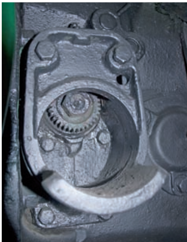
Fot. 47. Widok napędu prądnicy ze skrzyni biegów ciągnika Ursus C45 po zdemontowaniu prądnicy. Zdjęcie eksponatu Muzeum ZM Ursus (fot. Bartosz Kryński)
