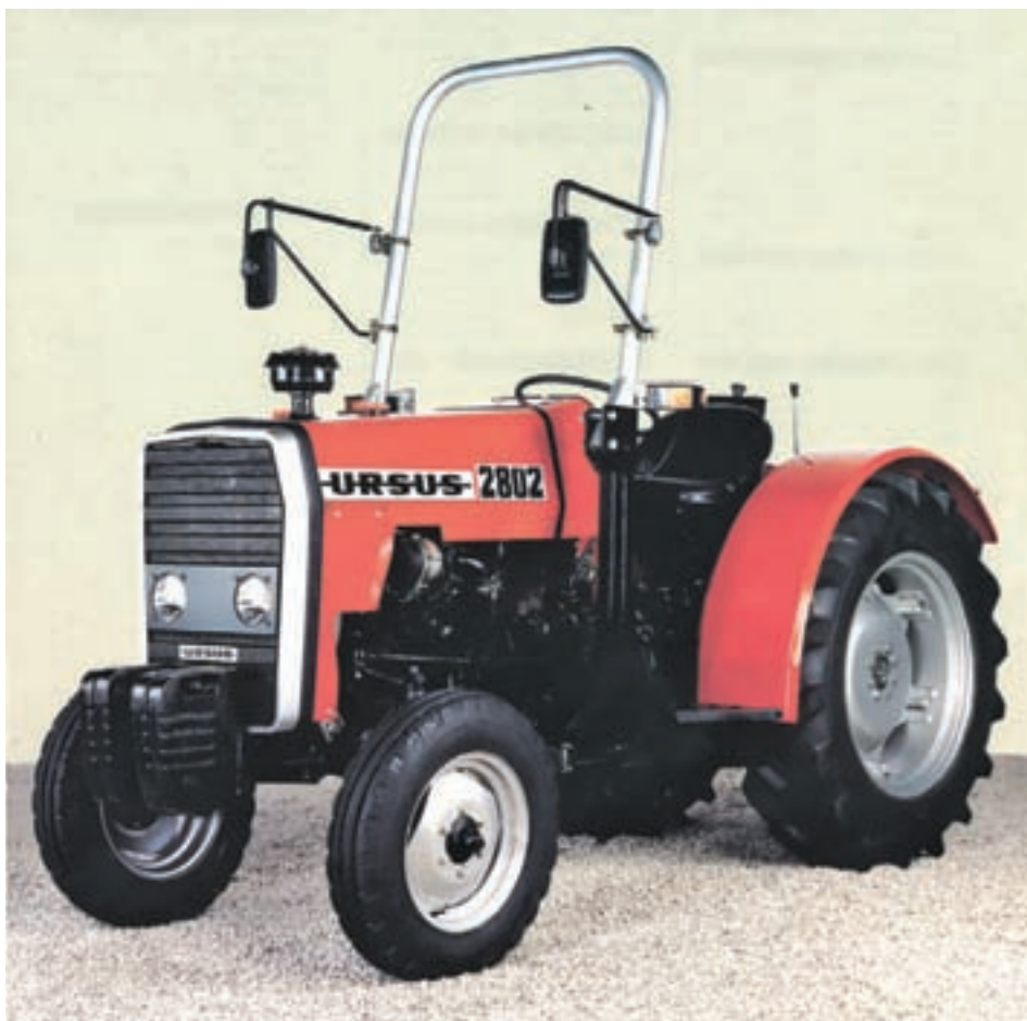
Fot. 149. Ciągnik sadowniczy Ursus 2802 z ramą ochronną, wąski – szerokość 1300 mm. Nie widać tu logo z niedźwiadkiem (według [31])
