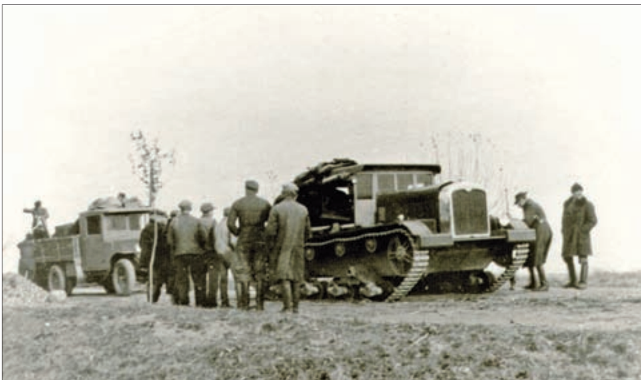
Fot. 30. Ciągnik gąsienicowy Ursus przeznaczony dla wojska, produkowany w FSC Ursus w Czechowicach w latach 1930-1939 (fot. ze zbiorów Muzeum ZM Ursus)
