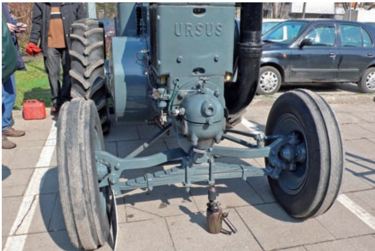
Fot. 45. Ciągnik Ursus C451 odrestaurowany i wystawiony przez Zbigniewa Nowosielskiego na Wydziale SIMR Politechniki Warszawskiej. Dobrze widoczna resorowana przednia oś (fot. Bartosz Kryński)
