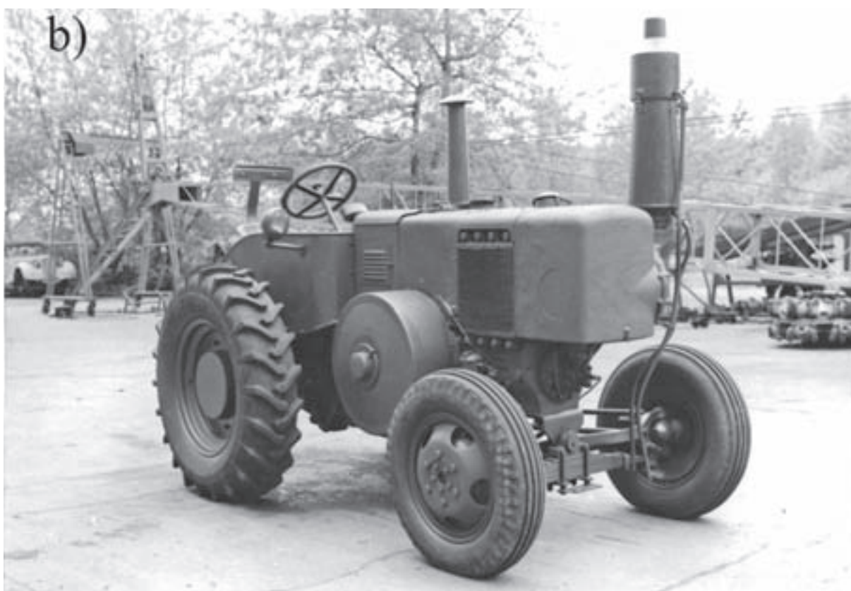
Fot. 51. Rok 1957, zmodernizowany przez prof. Habicha ciągnik C45 stoi na podwórzu Wydziału SIC Politechniki Warszawskiej: a) widok z lewej strony z przebudowanym układem wydechowym, b) widok z prawej strony, nie ma już wyjścia na ręczny rozruch za pomocą wyjmowanej kierownicy (ze zbiorów Katedry Ciągników PW, fot. H. Rosiak)
