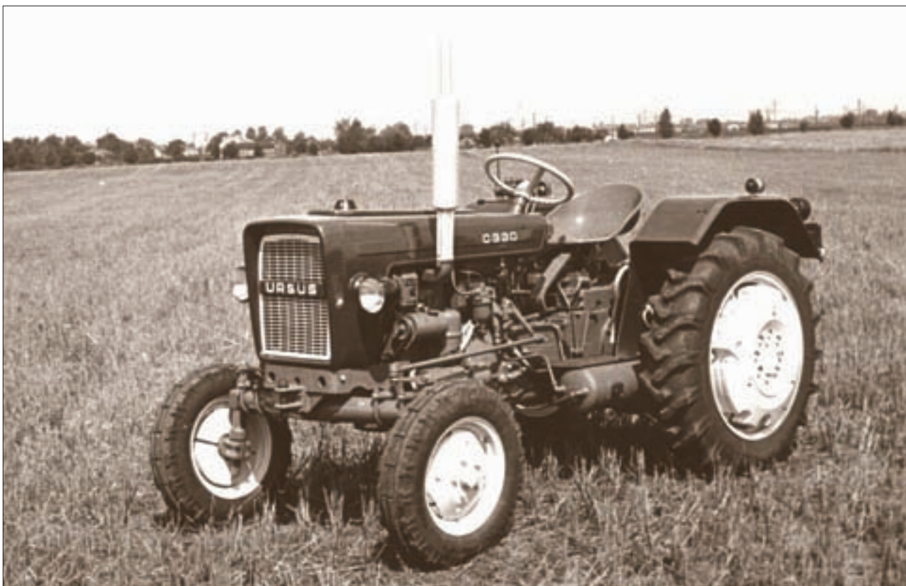
Fot. 72. Ciągnik Ursus C-330. Widoczna zmieniona w stosunku do Ursusa C-325 i C-328 maska i logo (ze zbiorów Muzeum ZM Ursus)
