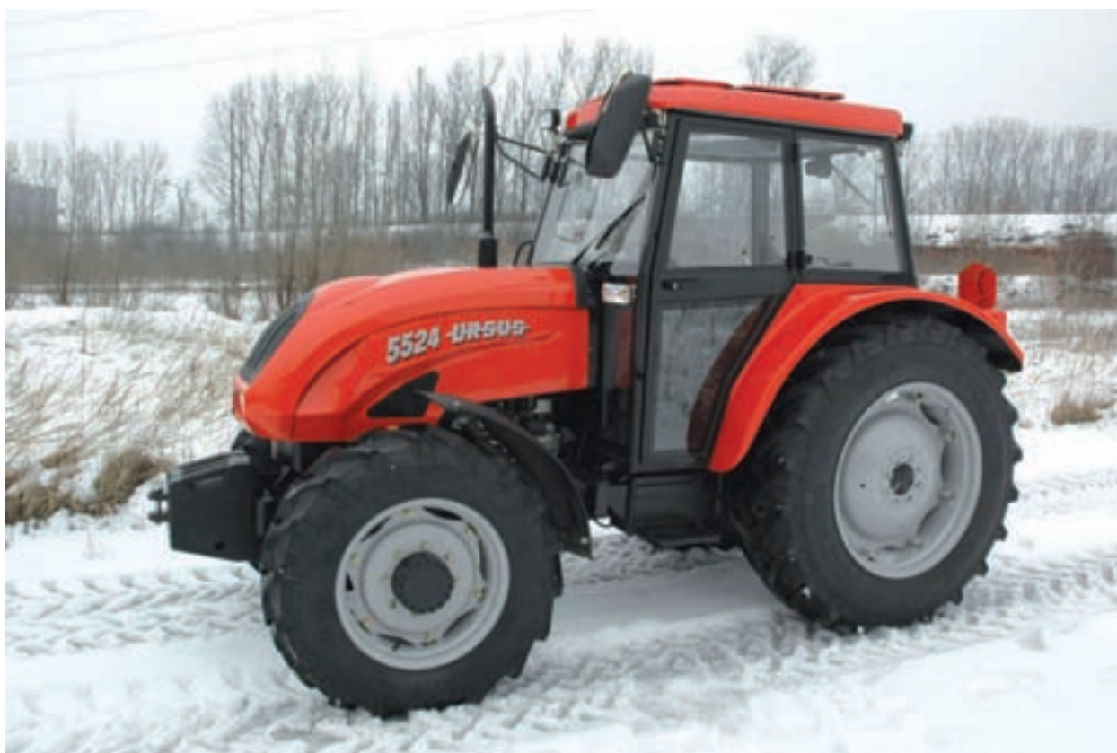
Fot. 159. Ciągnik Ursus 5524 z silnikiem 4 cylindrowym 55,5 kW Perkins IIIA produkowany od 2009 r. (ze zbiorów Muzeum ZM Ursus)
