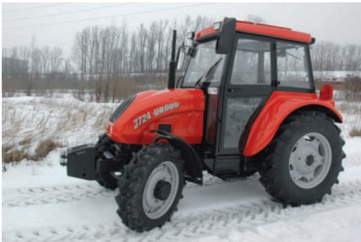
Fot. 158. Ciągnik Ursus 3724 z silnikiem 3 cylindrowym 36,9 kW Perkins IIIA produkowany od 2009 r. (ze zbiorów Muzeum ZM Ursus)
