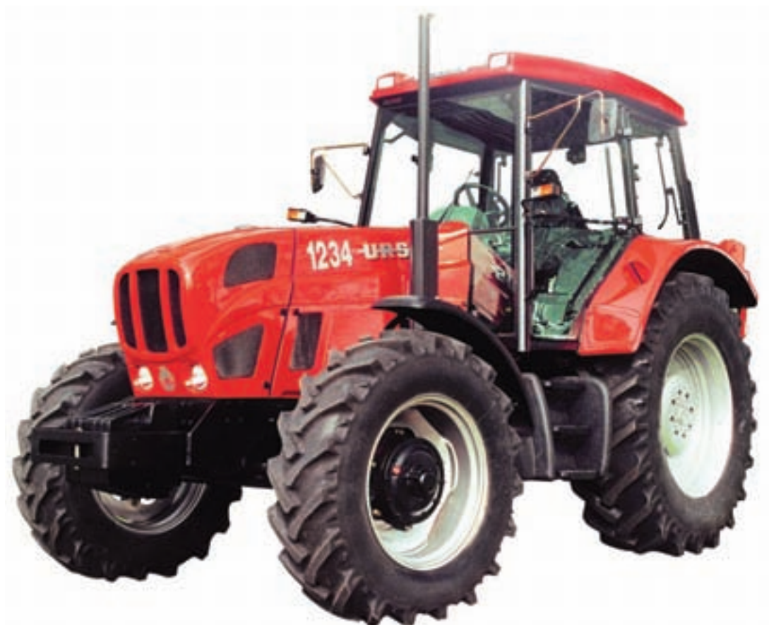
Fot. 171. Ciągnik Ursus 1234 z silnikiem 86 kW w nowej stylistyce z maską i dachem kabiny z tworzywa (ze zbiorów Muzeum ZM Ursus)
