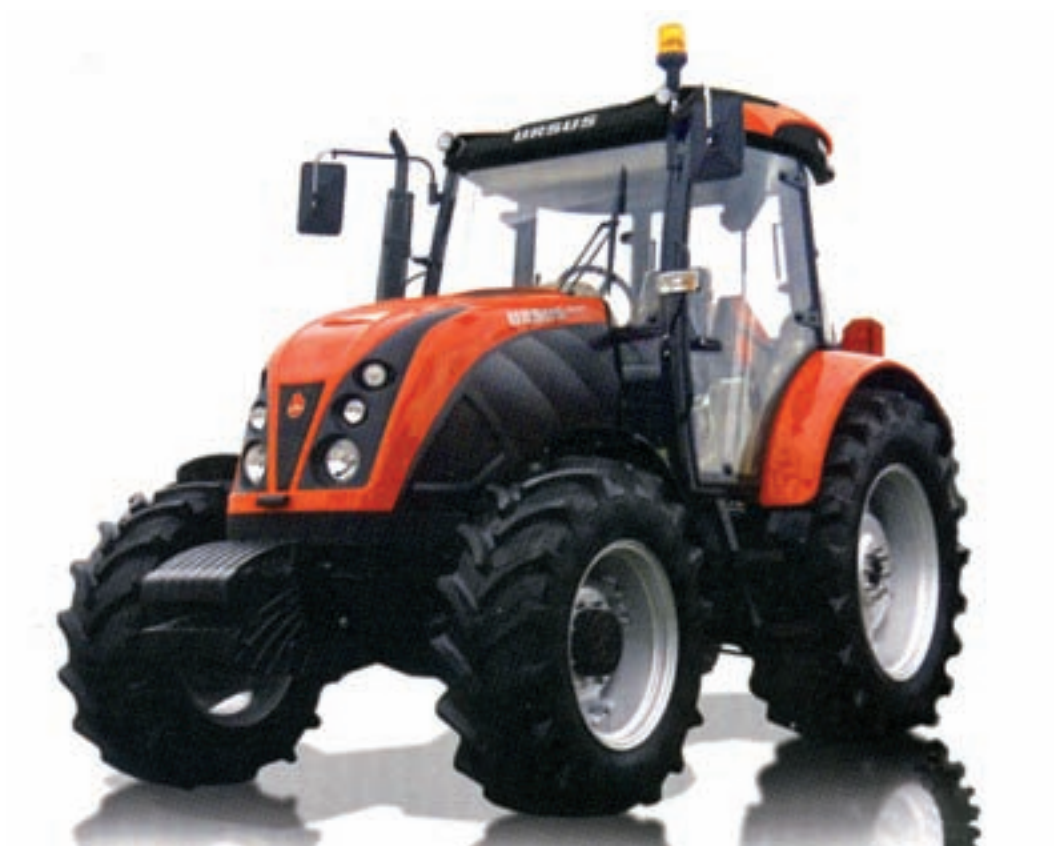
Fot. 184. Ciągnik URSUS 11034H firmy Ursus SA [38]: silnik turbodiesel Perkins 854E EURO IIIB moc 113 KM, skrzynia biegów 24/24 Carraro synchronizowana, napęd 4x4, most przedni Carraro, podnośnik EHR, układ kierowniczy pełnohydrauliczny
