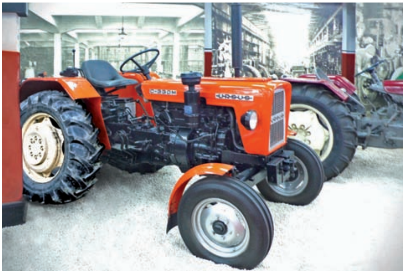
Fot. 80. Ciągnik Ursus C-330 M wystawiony w Muzeum ZM Ursus. Był to przejściowy model między C-330 i C-335. Widać zmienione w stosunku do C-330 zawieszenie siodła kierowcy (fot. Bartosz Kryński)
