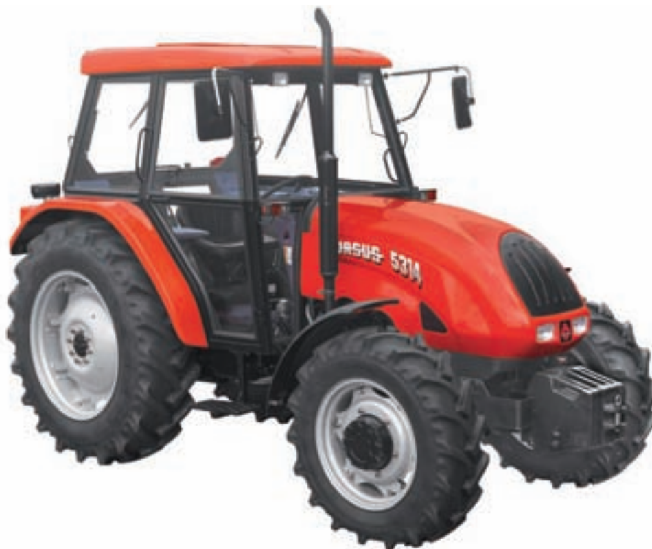
Fot. 157. Ciągnik Ursus 5314 z silnikiem 53 kW wersja z napędzaną osią przednią i maską z tworzywa sztucznego produkowana od 2002 r. (ze zbiorów Muzeum ZM Ursus)
