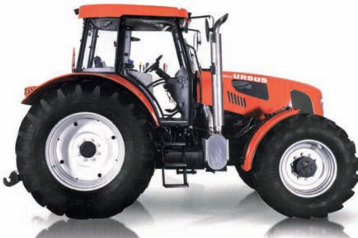
Fot. 186. Ciągnik URSUS 15014 firmy Ursus SA [38]: silnik turbodiesel SISU 66AW1 EURO IIIB moc 148 KM, skrzynia biegów ZF 40/40 z rewersem elektrohydraulicznym, napęd 4x4, most przedni Carraro, podnośnik EHR, układ kierowniczy pełnohydrauliczny
