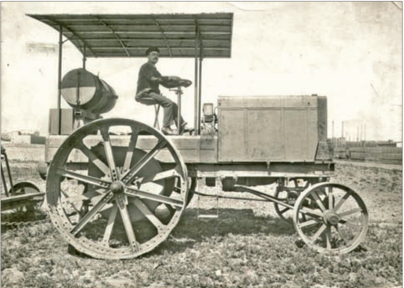
Fot. 6. Pierwszy polski ciągnik rolniczy zbudowany w 1918 r. przez Kazimierza Taylora, wzorowany na amerykańskim ciągniku TITAN firmy IHC (fot. ze zbiorów Muzeum ZM Ursus)
