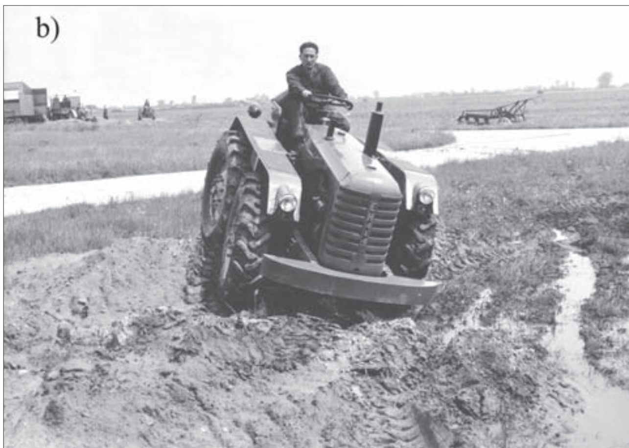
Fot. 59. Badania prototypów ciągnika EH 4x4 prowadzone w IBMER w Kłudzienku a) pełny skręt na łące, b) jazda w trudnym terenie (ze zbiorów Katedry Ciągników PW, fot. H. Rosiak)
