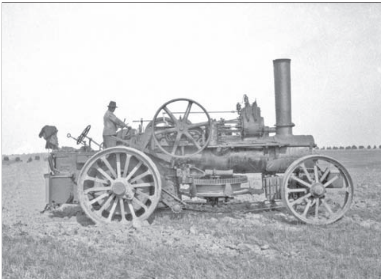
Fot. 25. Lokomobila parowa wykonująca w majątku „Nawra” orkę pługiem ciągnionym liną. Między osiami kół widoczny napędzany bęben z nawiniętą liną, do której był zaczepiany zestaw pługów (fot ze zbiorów rodziny Szczanieckich, właścicieli majątku „Nawra”)
