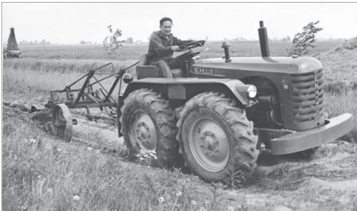
Fot. 60. Rok 1957, orka ciągnikiem EH 4x4 wersja II, badania prowadzone w IBMER w Kłudzienku (ze zbiorów Katedry Ciągników PW, fot. H. Rosiak)
