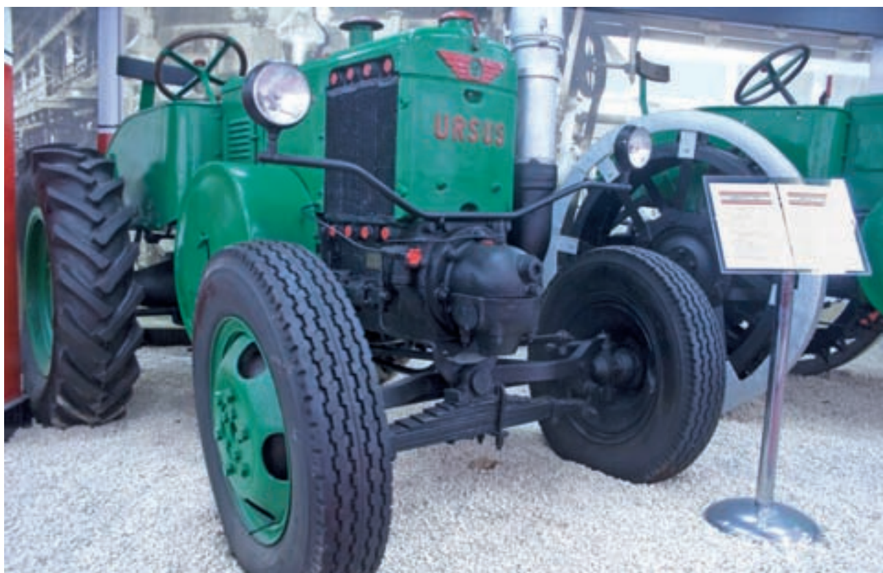
Fot. 48. Ciągnik Ursus C45 już z instalacją oświetleniową, kołami ogumionymi i zmienionym logo, z którego usunięto napis PZInż. Ale pozostał symbol PZInż u góry. Zdjęcie eksponatu Muzeum ZM Ursus (fot. Bartosz Kryński)
