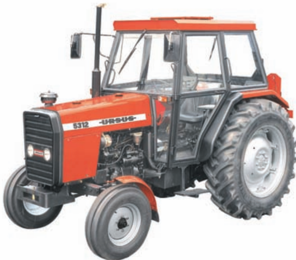
Fot. 155. Ciągnik Ursus 5312 z silnikiem 4 cylindrowym 53 kW produkowany od 1993 roku (ze zbiorów Muzeum ZM Ursus)
