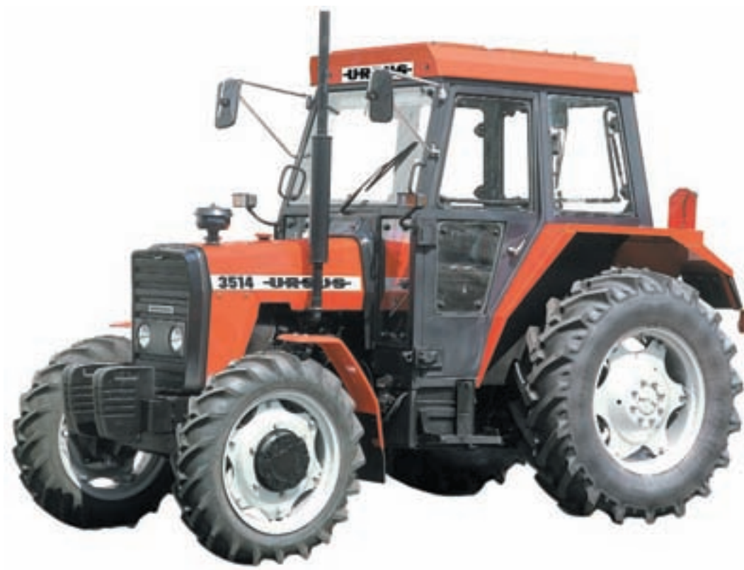
Fot. 153. Ciągnik Ursus 3514, wersja ciągnika 3512 z napędem na oś przednią (ze zbiorów Muzeum ZM Ursus)
