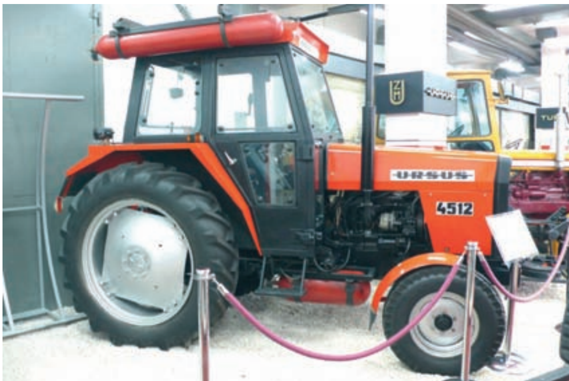
Fot. 154. Ciągnik Ursus 4512 z silnikiem 44 kW wersja z instalacją gazową, zdjęcie eksponatu Muzeum ZM Ursus (fot. Bartosz Kryński)
